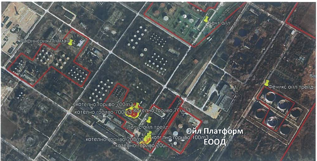
Фиг. 4-5-4-8 Въздействие на пожара от повърхността на разлив от котелно гориво върху площадката на „Лотус ойл трейд“ ЕООД и съседните обекти
