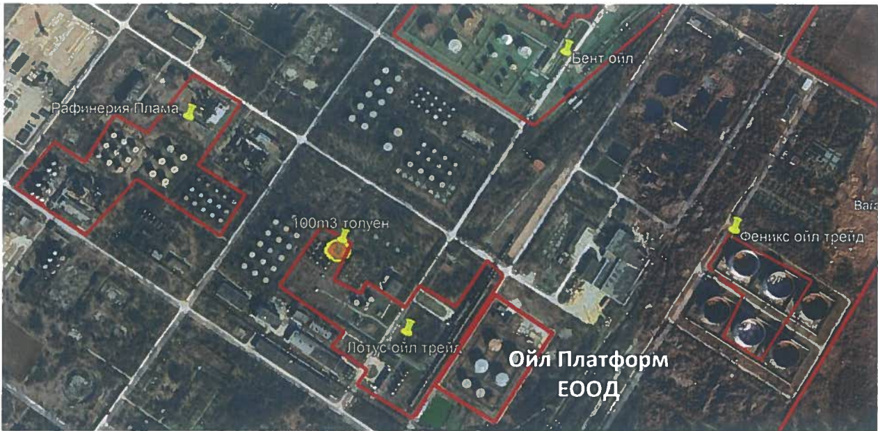
Фиг.4-5-4-4 Въздействие на пожара от повърхността на разлив от толуен върху площадката на „Лотус ойл трейд“ ЕООД и съседните обекти
