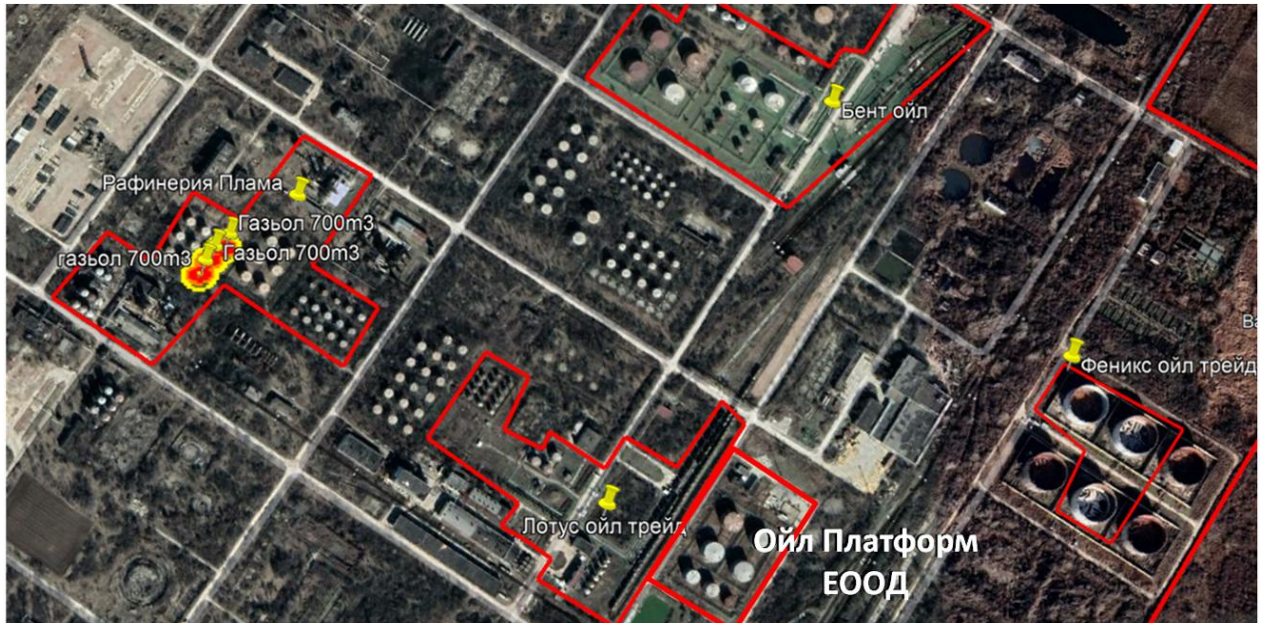
Фиг. 4-5-5-2 Въздействие на пожара от повърхността на разлив от дизелово гориво върху площадката на „РАФИНЕРИЯ ПЛАМА“ АД и съседните обекти
