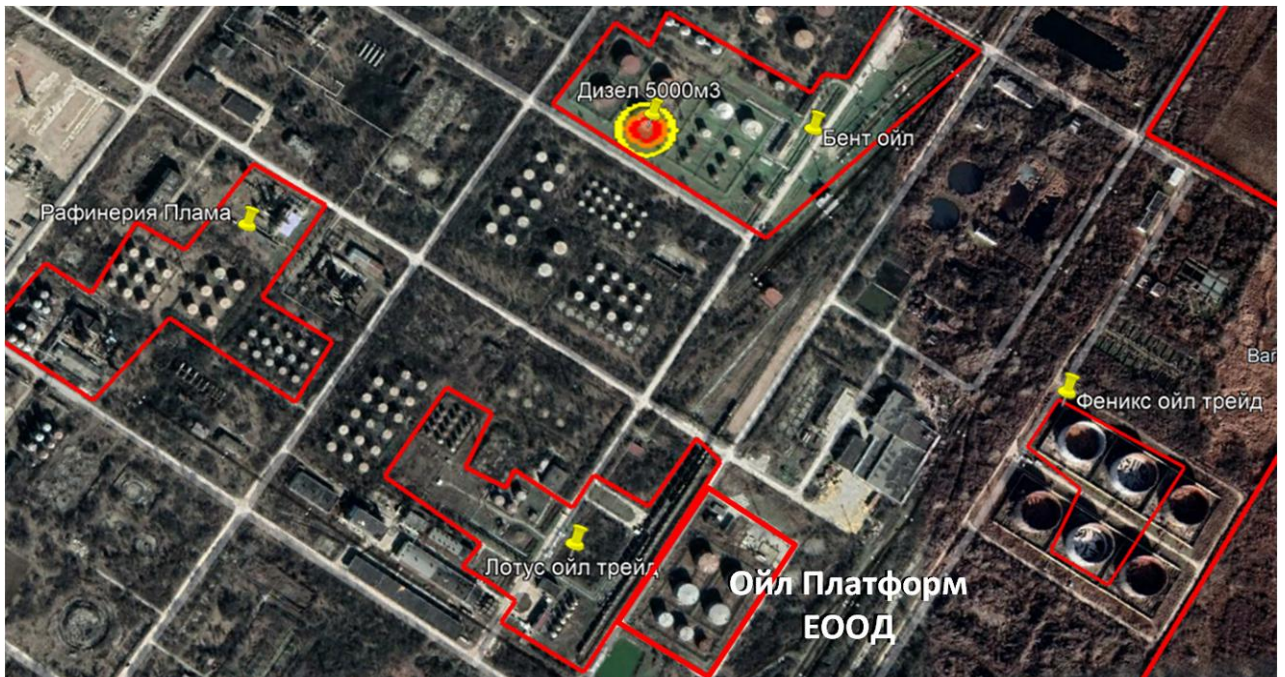
Фиг. 4-5-7-2 Въздействие на пожара от повърхността на разлив от дизелово гориво върху площадката на „БЕНТ ОЙЛ“ АД и съседните обекти
